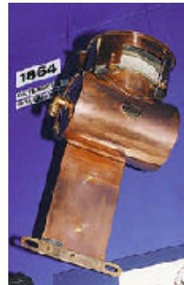
Le régulateur Rouquayrol-Denayrouze de 1864
